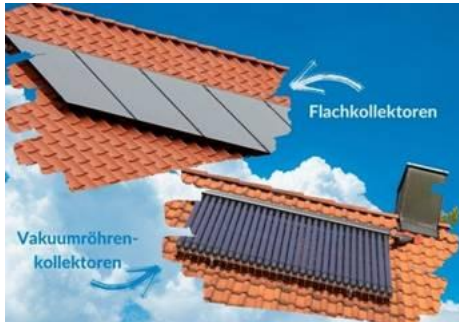
Abbildung 29: Typische Solarthermiekollektoren für Dachflächen: Flachkollektoren und Vakuummöhrnenkollektoren [12]
